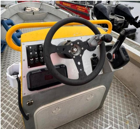
Zusätzlich wurde durch die Neuordnung der Bordbatterie unterhalb des Steuerstandes mehr Stauraum für Einsatzmaterial geschaffen. Desweiteren wurden neue Staufächer für weitere Funkgeräte, die
